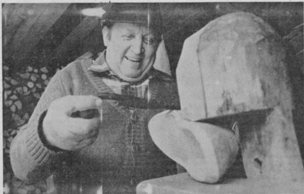
Zlodejev Stanko rad sedi v lopi na «kobili» in s «strupom» oblikuje kos lipovega ali javorjeva lesa, ki ga spreminja v pohorske cokle.
