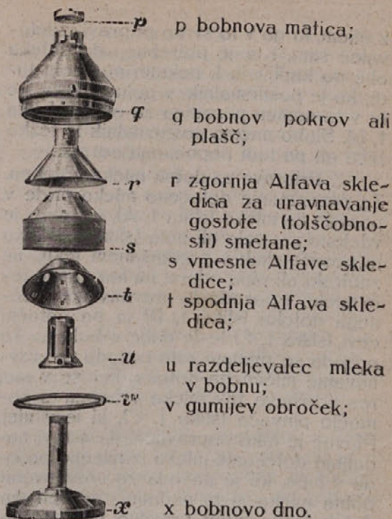
Slika 2. — Deli posnemalnikovega bobna.
