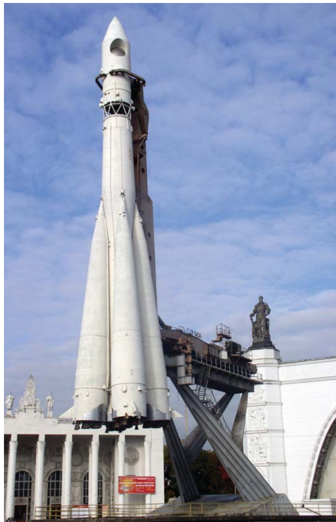
Na sliki je raketa R-7, različica Vostok 8 K 72 K, namenjena za polete prvih lunarnih sond Luna proti Luni in prototipov prvih enosedežnih vesoljskih ladij s posadko vrste Vostok. Raketa je razstavljena v ruskem razstaviščnem centru v Moskvi (All-Russian Exhibition Center). Foto: Wikipedia
