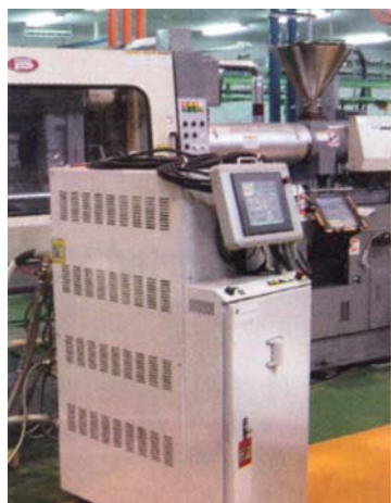
Oprema, nujno potrebna za izvedbo postopka RHCM, vključuje enoto za regulacijo temperature orodja, enoto za oskrbo s paro in ustrezen pribor. Podobno postavitev je npr. prikazal Sysco Corp., Japonska, na mednarodnem sejmu plastike leta 2005 (Tokio, Japonska).
