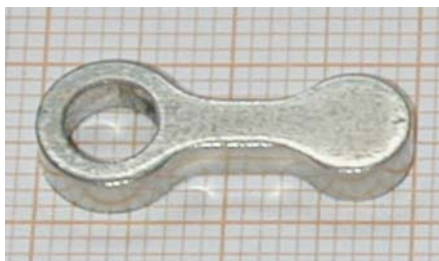
Slika 2: Segment mehanizma turbopolnilnika, ki je izdelan iz zlitine Inconel 718
