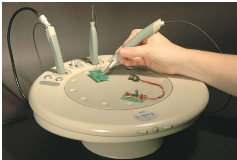
Smart Opt Soldering Station (študentski dizajn – zlato): Prilagodljiva »postaja« za spajkanje s pomožnimi orodji omogoča boljše in lažje delo ter zmanjšuje tveganje poškodb, bolečin v hrbtu in vratu, glavobola ter utrujenih oči, obenem pa zmanjšuje utrujenost. (Razvoj in dizajn: Natalie Schraufnager, Milwaukee Institute of Art and Design)
