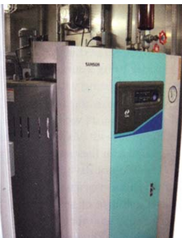
Oprema, nujno potrebna za izvedbo postopka RHCM, vključuje enoto za regulacijo temperature orodja, enoto za oskrbo s paro in ustrezen pribor. Podobno postavitev je npr. prikazal Sysco Corp., Japonska, na mednarodnem sejmu plastike leta 2005 (Tokio, Japonska).
