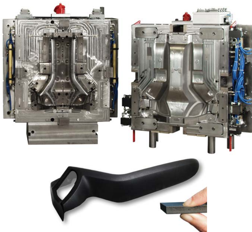
Dvokomponentno orodje: osrednja vrtljiva plošča (levo) in fiksna polovica orodja (desno) za izdelavo »teksturne« površine in pene, mehke na otip
