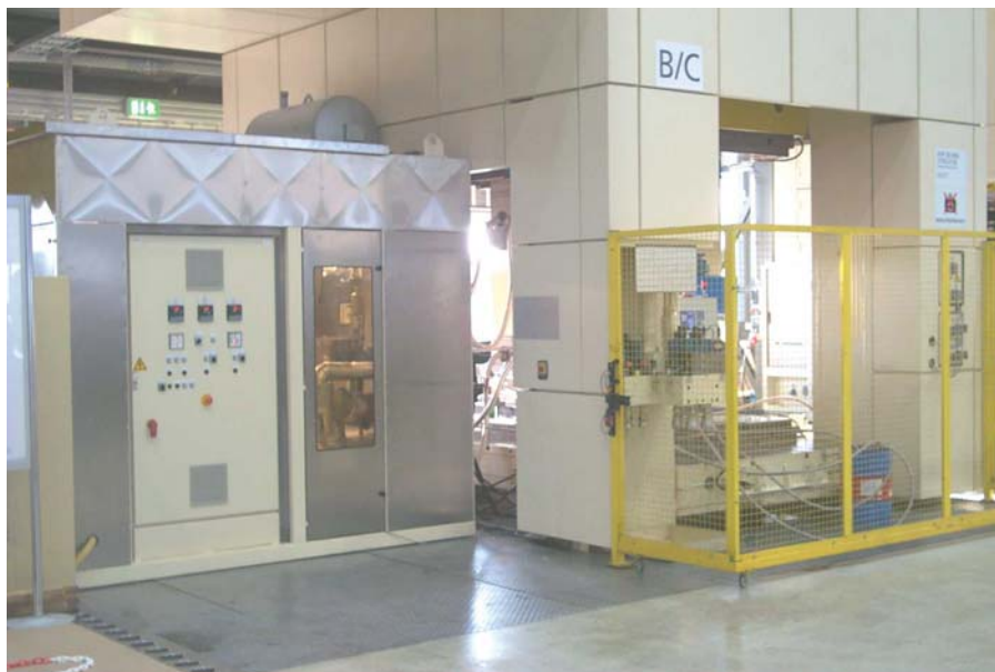
Grelnik: Naprava za segrevanje medija z integriranim tlačnim transformatorjem dopolnjuje sosednjo IHU-napravo (50.000 kN) z vgrajenim T-IHU-orođjem.
