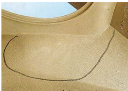
Slika 5: Podoba žarkov za ostrimi prehodi v orodju
