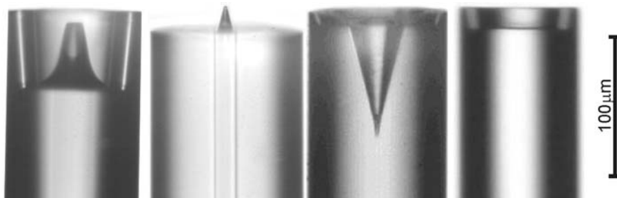
Različne strukture na vrhu optičnih vlaken, ki so bile izdelane v Laboratoriju za optoelektrične in senzorske sisteme (foto: dr. Denis Donlagič)
