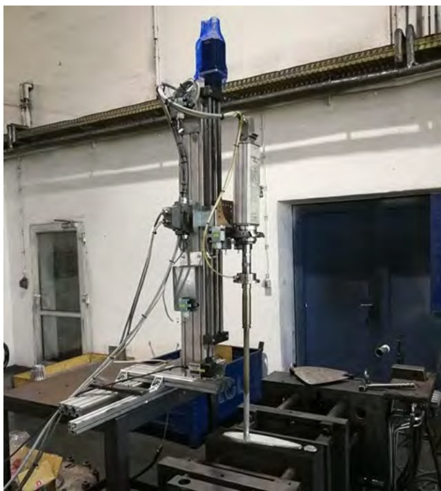
Slika 4. Uporaba ultrazvoka za obdelavo aluminijevega ulitka v kalupu
