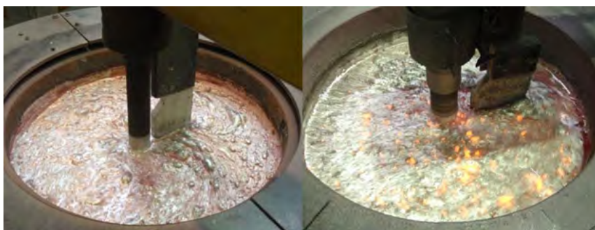
Slika 6. Razplinjevanje (levo) in doplinjevanje (desno) aluminijeve taline
