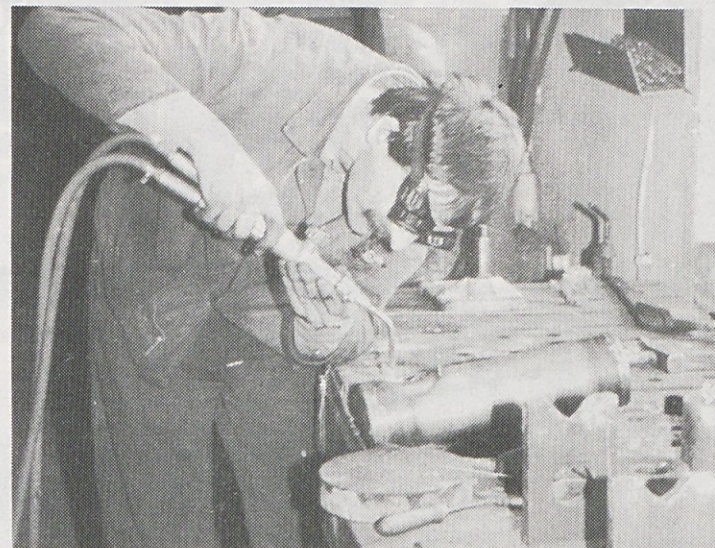
Avtogeno varjenje v kovačnici
