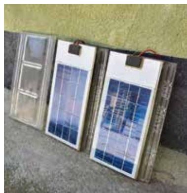
Prototipi fotovoltaičnih strešnikov, ki jih je izdelal Ciril Glivar iz Brezovega Dola pri Zagradcu leta 2010. Foto: Dušan Štepec
