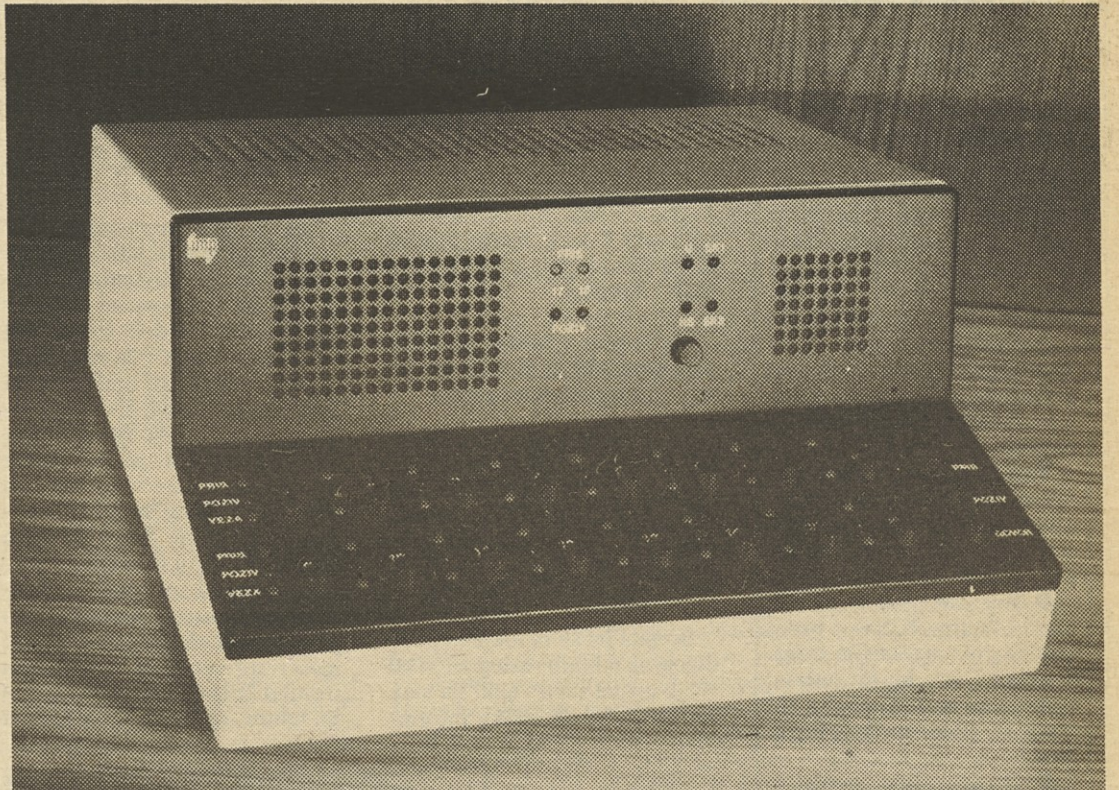
Sestrski aparat Telekomovega bolnišničnega sistema SKN-S6. Ta sistem ima poleg svetlobne signalizacije tudi možnost interfonskih pogovorov med sestro in pacienti v sobah.
