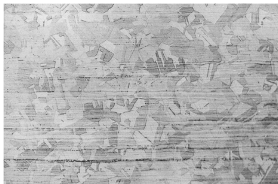
Sl. 3. Mikrostruktura osnovnega materiala cevi
