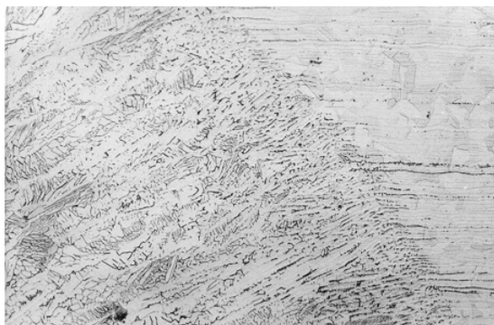
Sl. 5. Prehod iz zvara v osnovni material
