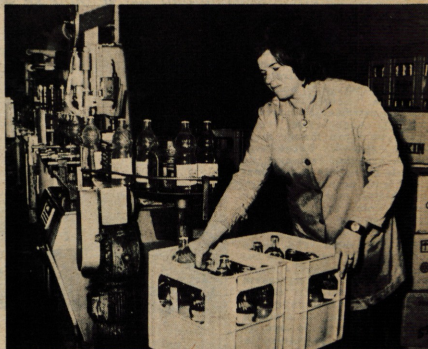
V tej polnilnici olja v Britofu napolnijo na uro 2400 steklenic jedilnega olja.
