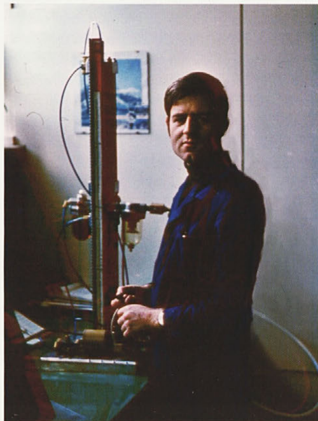
Priprava za testiranje tesnosti potopnih črpalk 1980 (lastna konstrukcija in izdelava)
