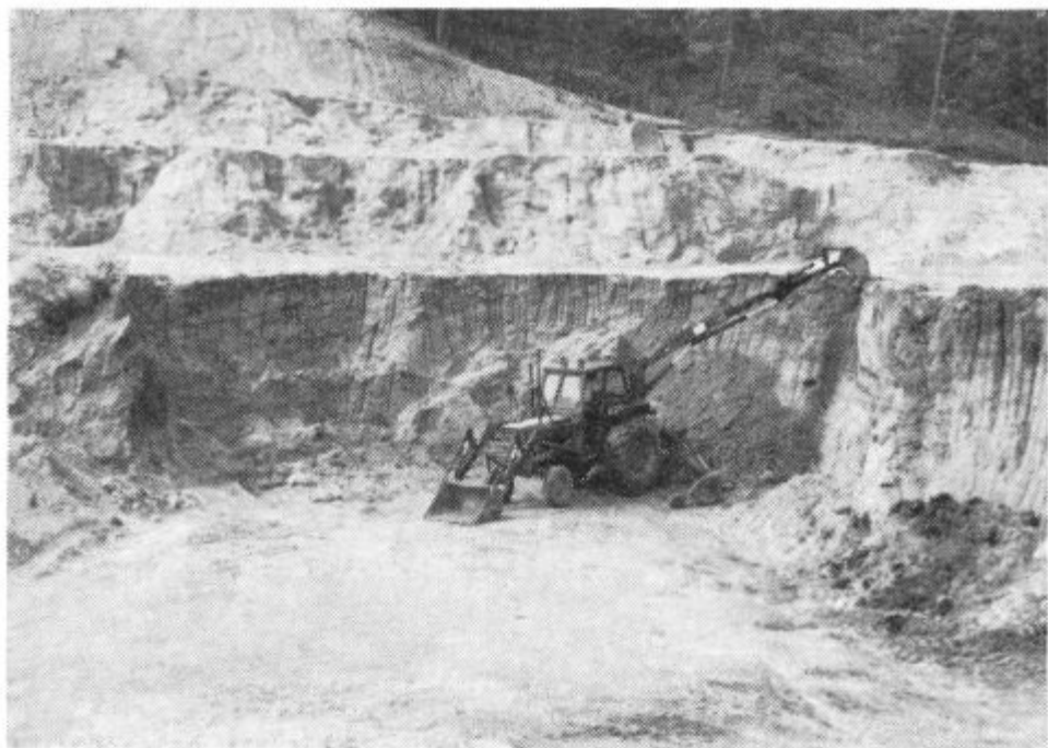
Peskokop Vrhe. Etažni odkop kremenovega peska
