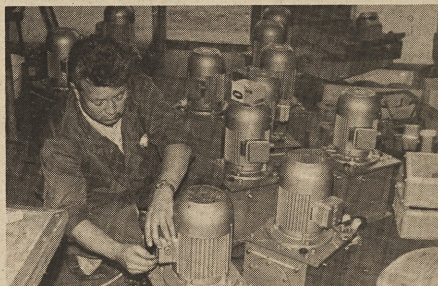
Montaža hidravličnih agregatov za opremo betonarn.
