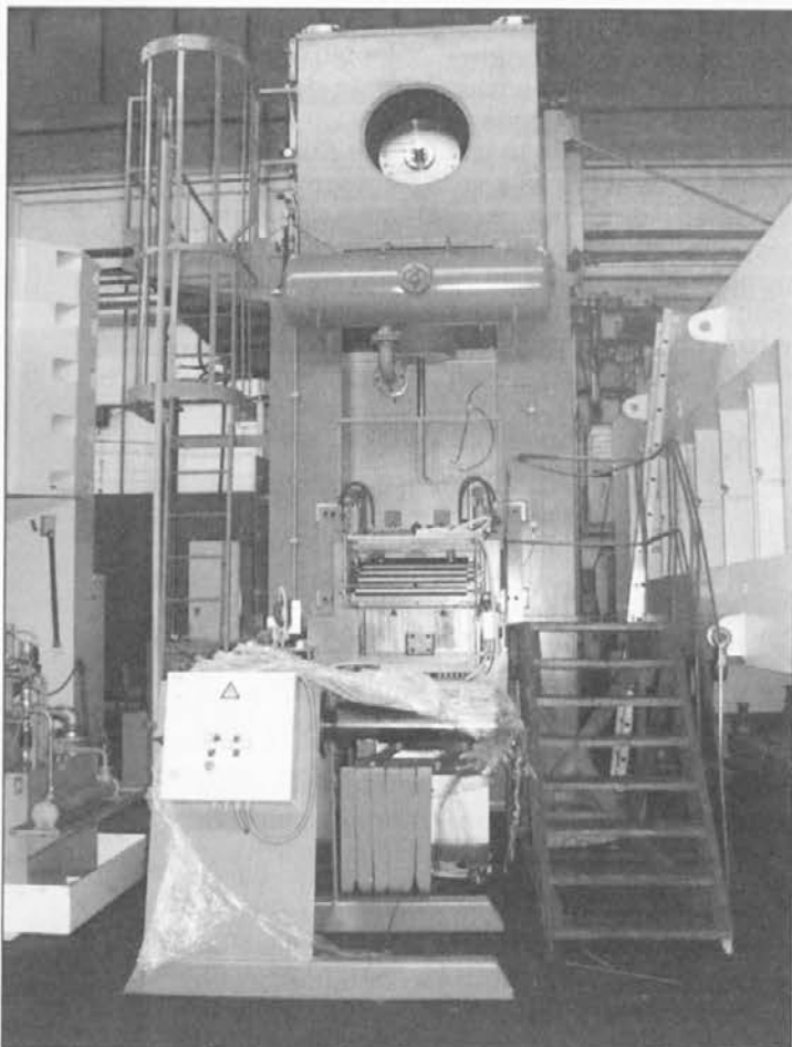
500-tonska stiskalnica v fazi montaže.
