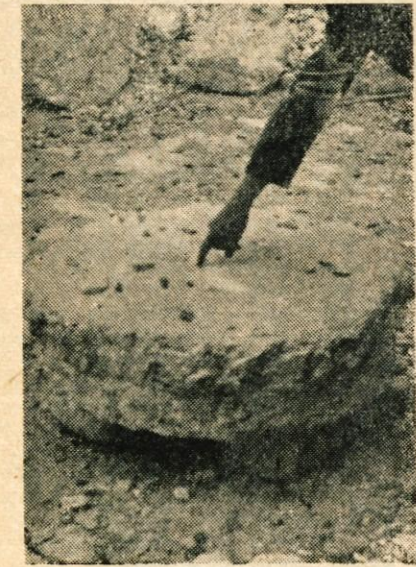
Na pol izdelan kamen, odluščen od matične kamenine, je treba še dokončno obdelati. Roka kaže mesto, kjer bo treba še izklesati luknjo
