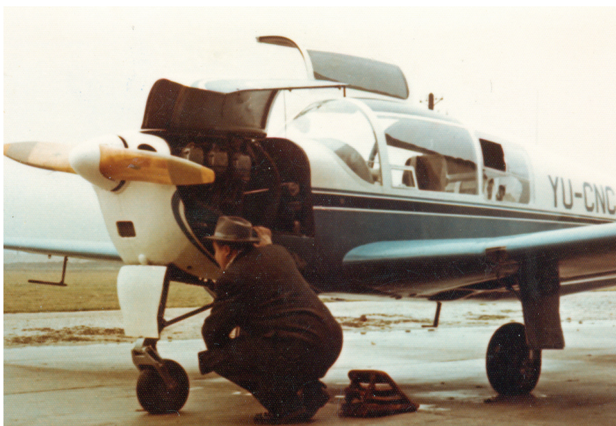
Preverjanje motorja in sprednjega kolesa pred letom prototipa, ki je dobil registrsko oznako YU-CNC. (Vir: zbirka Marka Malca)
