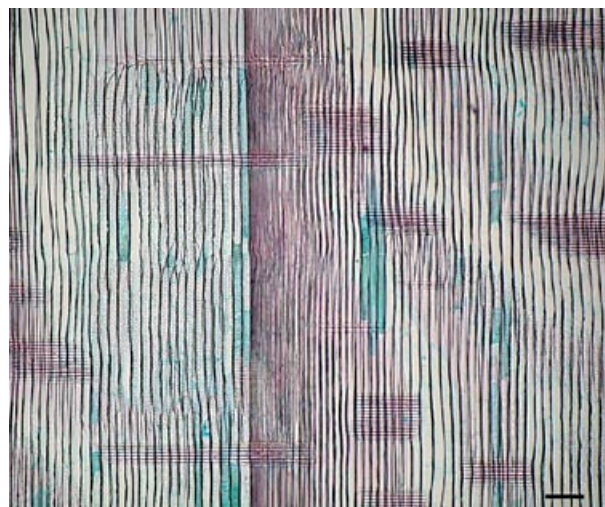
■ Slika 3. Montana vosek (LGE-A) v sredini vzorca A (20 x 20 x 20) mm. Merilna daljica = 100 µm.
