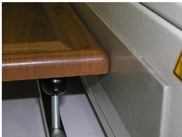
■ Slika 4. Tesni dotik robne ploskve preskušanca z grelno ploščo (foto: Borut Kričej)
