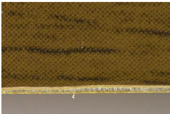
■ Slika 2. Zdrs roba nalepka, navzgor od spodnje ploskve, zaradi povečanih strižno nateznih napetosti v robnem nalepku in zmanjšane adhezijske trdnosti lepila (foto: Borut Kričej)
