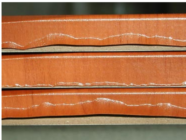
■ Slika 1. Oplaščene robne ploskve, deformirane zaradi učinka toplote (foto: Borut Kričej)
