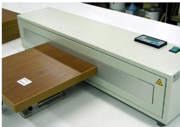
■ Slika 3. Naprava GP-70/6; robne ploskve elementov front kuhinjskega pohištva v stiku z grelno ploščo (foto: Borut Kričej)
