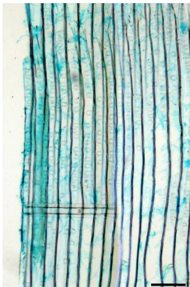
■ Slika 5. Vosek je v prečni smeri prodrl le v prve poškodovane celice. Merilna daljica = 100 µm. Fig. 5. Wax break through the first damaged cells in cross section only. Scale bar = 100 µm.
