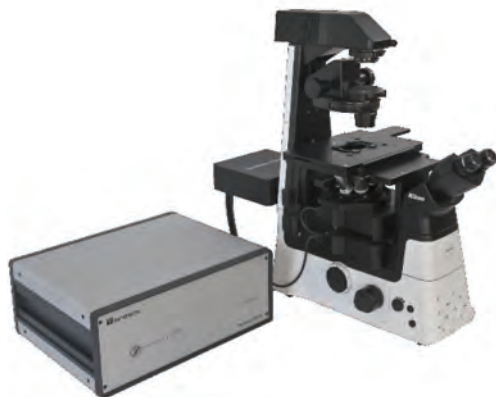
Slika 5: Optična pinceta slovenskega podjetja Aresis. Komercialnemu invertnemu raziskovalnemu mikroskopu sta dodana laser in sistem za vodenje snopa.
