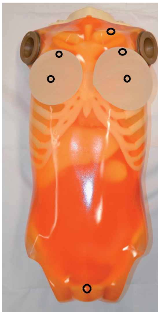
Slika 3: Točke na telesu fantoma, kjer so bili postavljeni dozimetri
