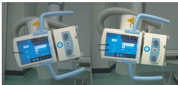
Slika 3: Nagib rentgenske cevi navzgor za centriranje zgornje točke (levo) in navzdol za centriranje spodnje točke (desno)
