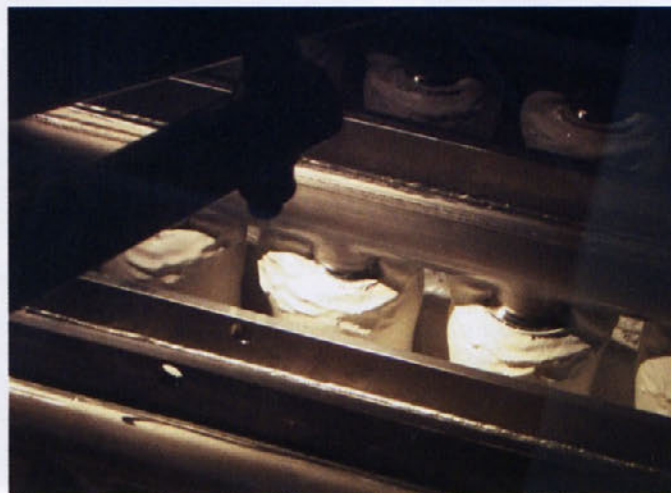
Pogled skozi ogledna stekla na pogače v filtru
