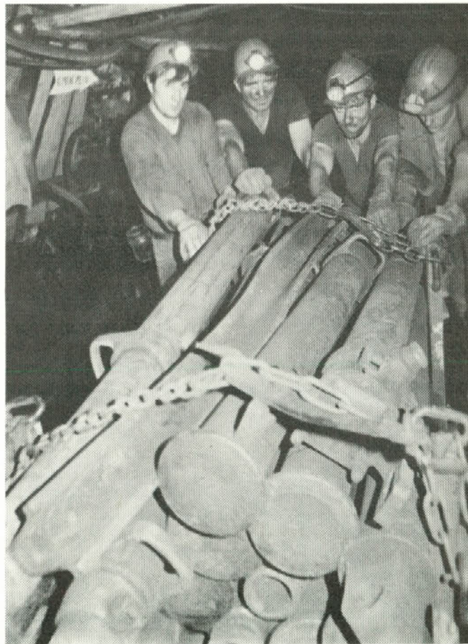
Pri spravilu jeklenega podporja v jami
