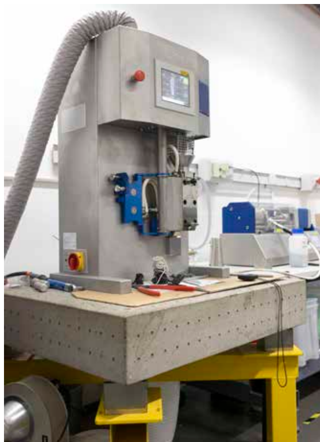
Slika 1 : Večnamenska naprava nove generacije za izdelavo in spremljanje tokovnega vedenja visoko koncentriranih multifunkcijskih naprednih materialov v majhnem volumnu (Foto: IFP, d. o. o.)
