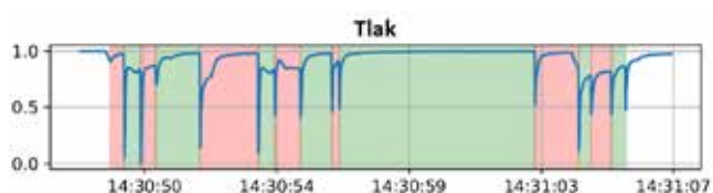
Slika 4 : Normirane tlačne meritve enega cikla naprave. Z izmenjujočo se barvo ozadja označeni posamezni koraki delovanja naprave.
