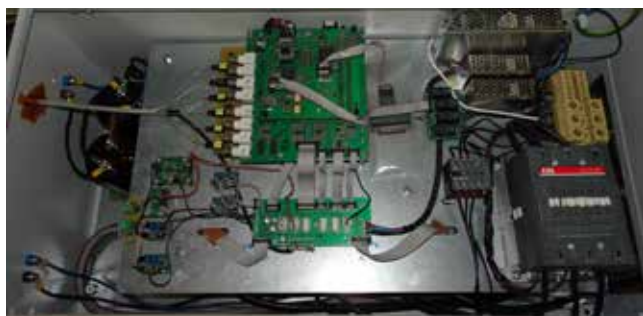
Slika 3 : Po meri izdelan laboratorijski frekvenčni pretvornik
