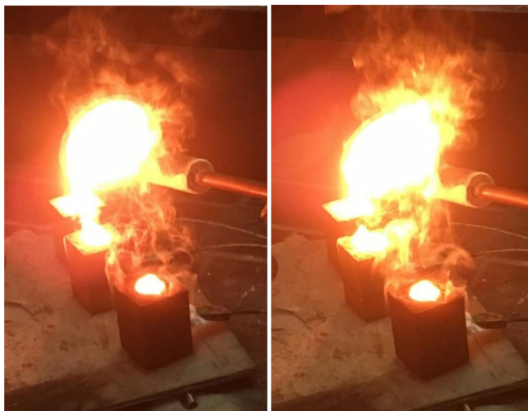
Sl. 3. Postopek vlivanja sive litine v peščene celice
