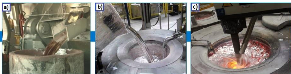
Sl. 1. Stopnje priprave taline: a) zlivanje iz talilne peči, b) prenos taline v zadrževalno peč in c) obdelava taline
