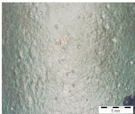
Sl. 7. Površina ulitka (10x povečava), kjer je bil uporabljen premaz S1 – 25
