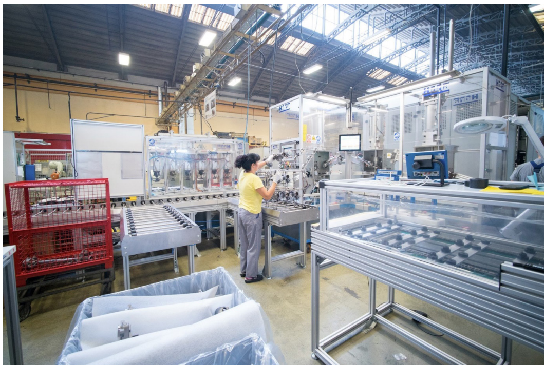
Sl. 5. Končna kontrola in kontrola tesnosti volanskih gredi v PE Hidria Alutec (avtor slike Robert Zabukovec)
