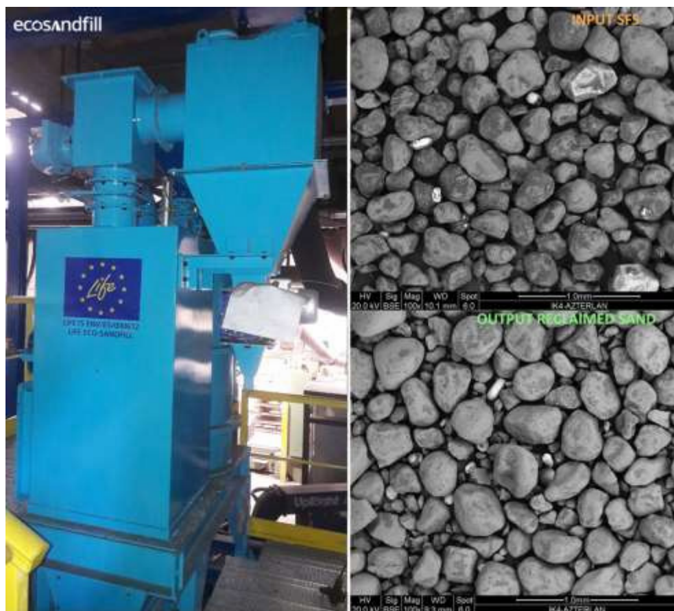
Sl. 3. Regeneracijski prototip LIFE ECO-SANDFILL, nameščen v družbi ESTANDA (levo), in primerjava posnetkov SEM (100-kratna povečava) kemično vezanega peska SFS (desno zgoraj) ter posnetek po obdelavi v sistemu (desno spodaj)
