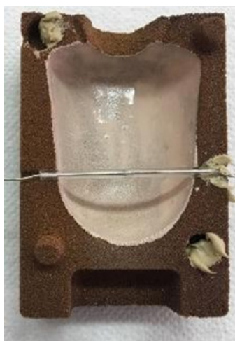
Sl. 1. Premazana celica z vstavljenim termoelementom, pred sušenjem
