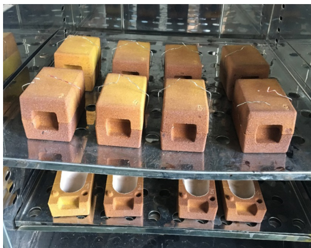
Sl. 2. Sušenje merilnih celic v peči
