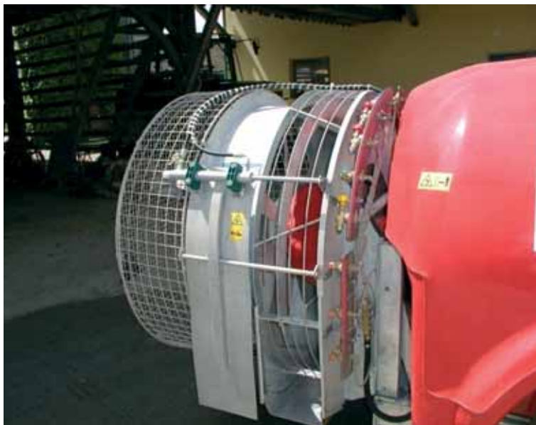
Sodobni pršilnik z vgrajenimi šobami za zmanjševanje zanašanja in enostransko zračno zaporo (foto: G. Leskošek)
