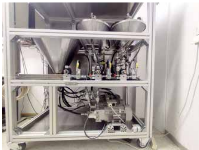
Slika 1 : Preizkuševališče petih zobniških črpalk, testiranih s srednjim testnim prahom, obrabnimi delci in brez dodajanja kontaminanta s filtracijo
