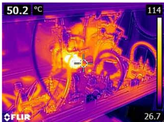
Slika 3 : Zaznavanje okvare zobniške črpalke
