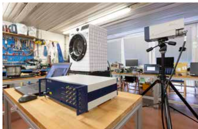
Slika 2 : Oprema za raziskave na področju razvoja hibridnih digitalnih dvojčkov za ovrednotenje vibracijske poškodovanosti naprav (Foto: IFP, d. o. o.)
