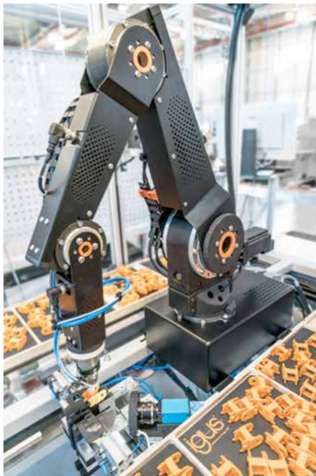
Slika 6 : Večosni robot robolink in portalni robot drylin z ujemajočo se krmilno enoto sta glavni komponenti stroja, ki ga v podjetju igus uporabljajo za sestavljanje energijskih verig.
