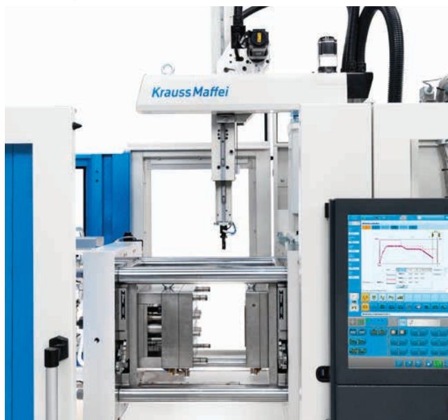
» Avtomatizacija procesa s 'pickerjem' SPX 10 za odstranjevanje dolivka
