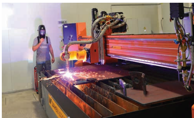
» Portalni CNC-rezalnik VARCUT s programljivo glavo za plazemsko 3D-rezanje (VARCUT 3,2 L2-3D/EP-2x6m/1PL-R+2G)
