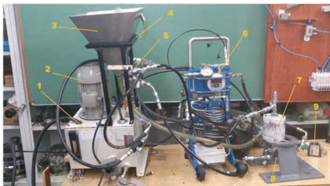
» Slika 1: Hidravlično preizkuševališče za testiranje filtrirnih membran po standardu
