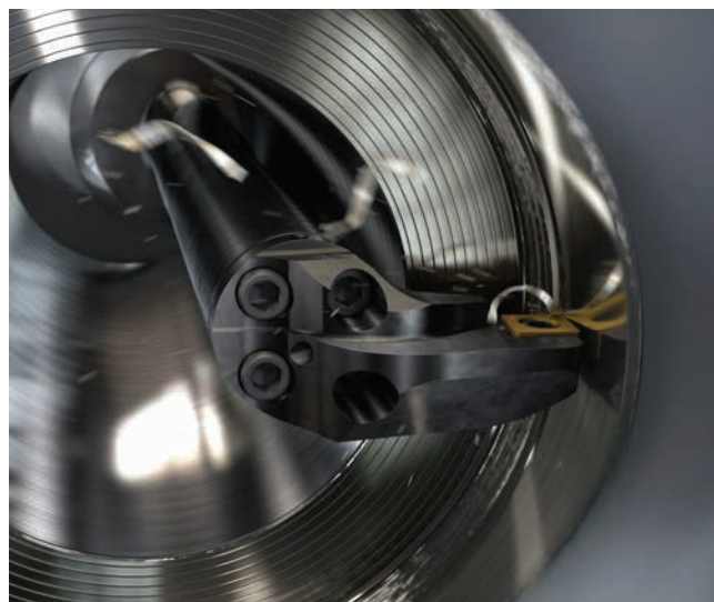
» Eliptični adapterji SilentTools™ so idealni za stabilno obdelavo pri ozkih prehodih in velikih prostih dolžinah.
