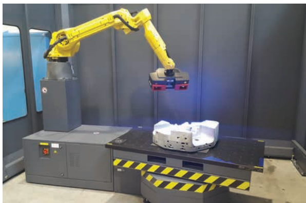
» Slika 16: Skeniranje gravure orodja za tlačno litje
