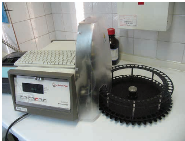
» Slika 2: Sodobni laboratorijski viskozimeter Stabinger SVM 3000/G2
