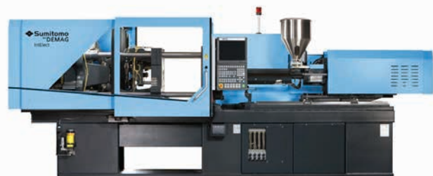
» Brizgalka IntElect 450t namenjena brizganju avtomobilskih žarometov
