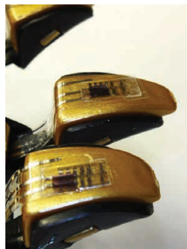
» Umetni mehanski receptorji na prstih robotske roke. | Foto: Bao Research Group, Stanford University
