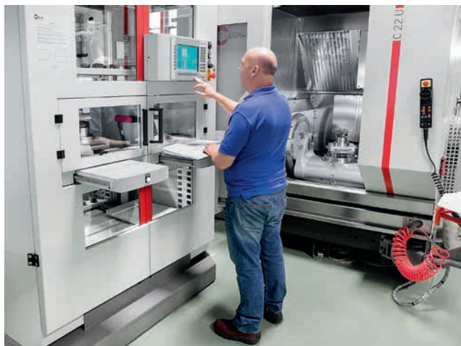
» Operater bo sprožil gibanje paletnega zalogovnika za začetek avtomatizirane proizvodnje.
