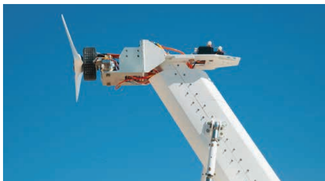
» Električni pogonski sistem je pritrjen na vrh testnega stojala Airvolt. Nanj so priključeni instrumenti za meritve in zbiranje podatkov. | Vir: NASA Photo / Lauren Hughes http://go.nasa.gov/2bUJ79v
