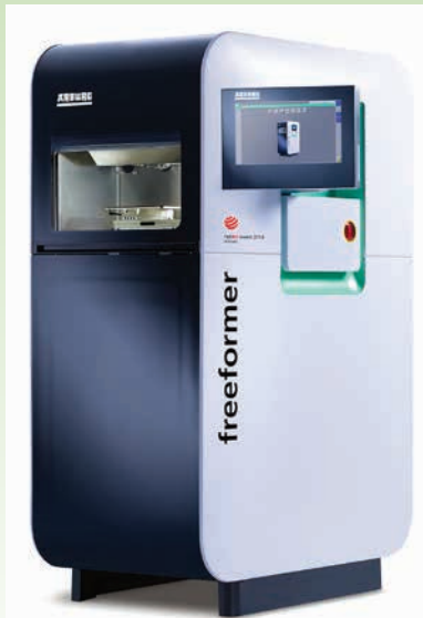
» Freeformer z izboljšano komoro - krmiljenje zraka in temperature v delovnem prostoru je bistveno izboljšano
