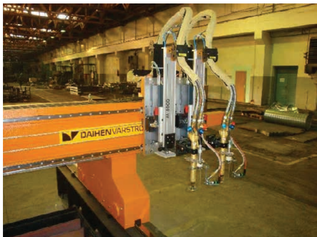
» CNC-rezalnik s programljivo 3D-glavo za obrezovanje/rezanje s plazmo HPR 400 XD in z 2 glavama za plamensko (avtogeno) rezanje
