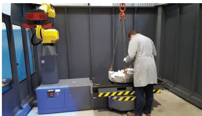
» Slika 3: Nalaganje s pomočjo mostovnega dvigala
