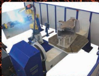
Linija za varjenje avtomobilskih okvirjev
