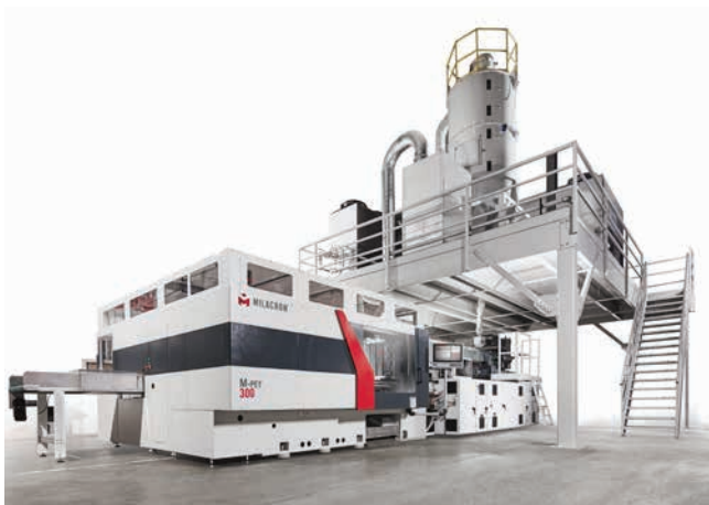
» Inovativen sistem za predoblikovanje PET s koinjekcijsko barierno tehnologijo – M-PET 300
