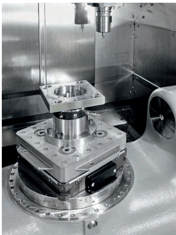
» Vpenjalna glava System 3R na mizi Hermle in paletni sistem GPS240, ki omogoča neoviran dostop za petosno obdelavo
