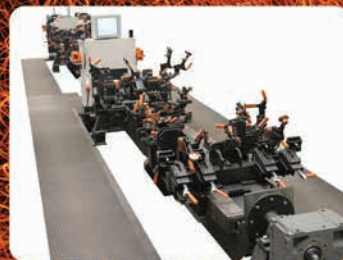
Varilna robotska celica s H-vrtljivo mizo in dvoosnim pozicionerjem
