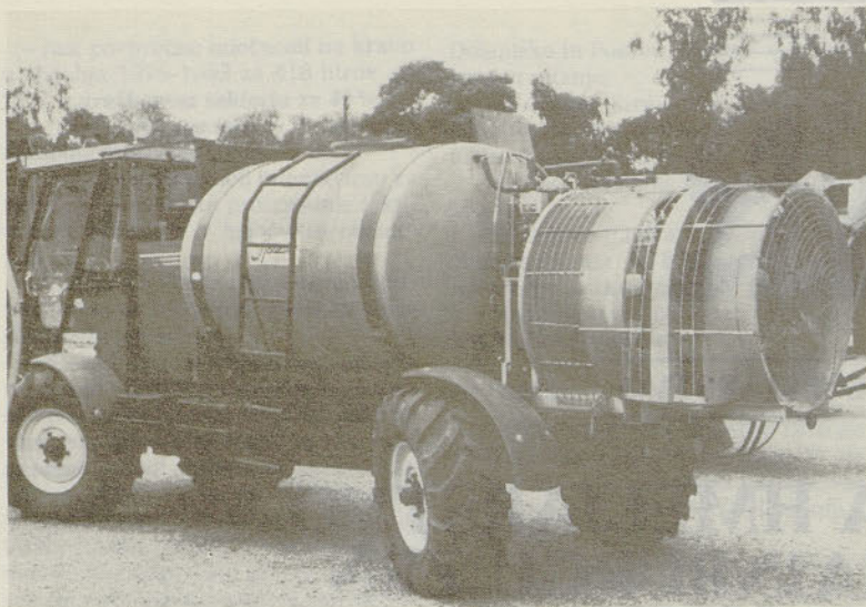
Samovozni 3000 l pršilnik velike zmogljivosti.
