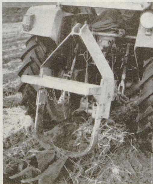
Izkopalnik brez vibracijskega pretresala je pomanjkljivo orodje.
