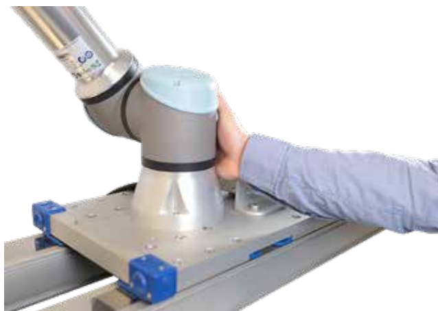
Namestitev kolaborativnega robota na Movotrak™ CTU (Vir: www.thomsonlinear.com )
