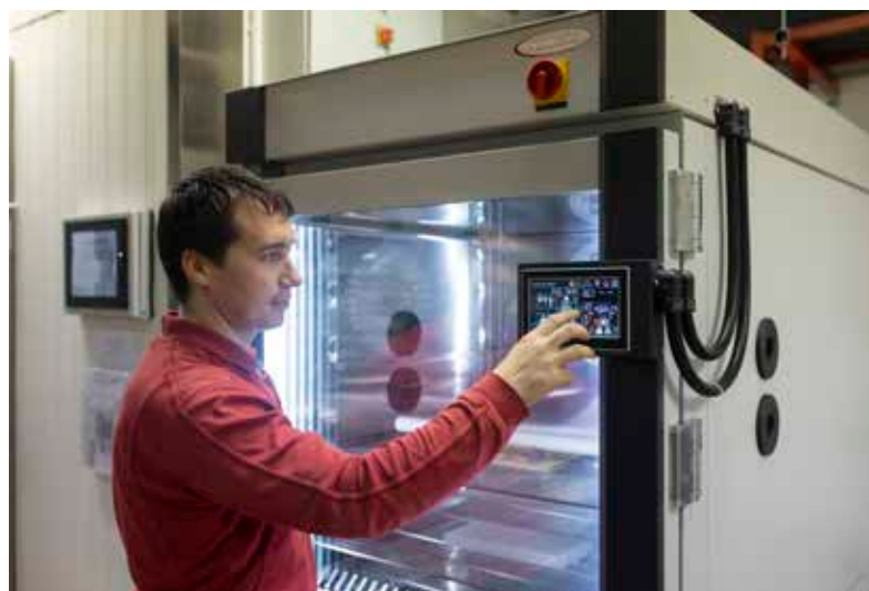
Slika 2 : Klimatska komora za karakterizacijo materialov in procesov (Foto: IFP, d. o. o.)
