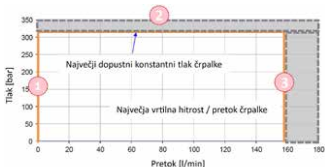
Slika 3 : Omejitve batne črpalke s spremenljivo iztislino
