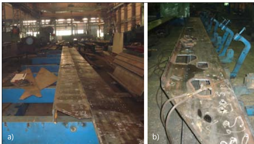
Slika 3. Vrtanje lukenj po šablonah (a) in izrezovanje lukenj s plamenskimi rezalniki (b)
