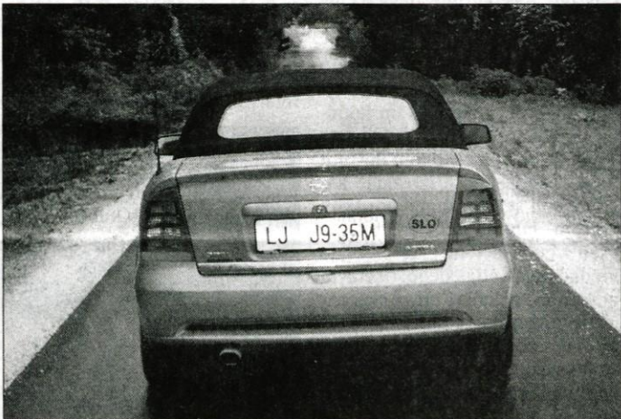
Platnena streha ima elektrificiran mehanizem, ki odpiranje ali razpiranje opravi v slabe pol minute.
