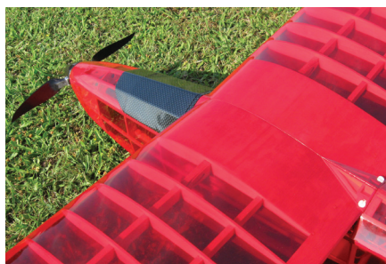
Pogled na sprednji del sestavljenega modela. Krila lepo sedejo na trup. Dobro je vidna pritrditev s plastičnimi vijaki M4.
