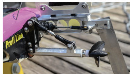
Celotno kovinsko ogrodje pogonskega sklopa tega modela je bilo narejeno v domači delavnici.
