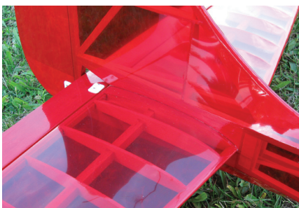
Skozi prozorno folijo se lepo vidi konstrukcija repa.
