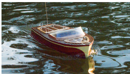
Oplata tega modela je iz treh plasti mahagonijevega furnirja, položenega pod različnimi koti.
