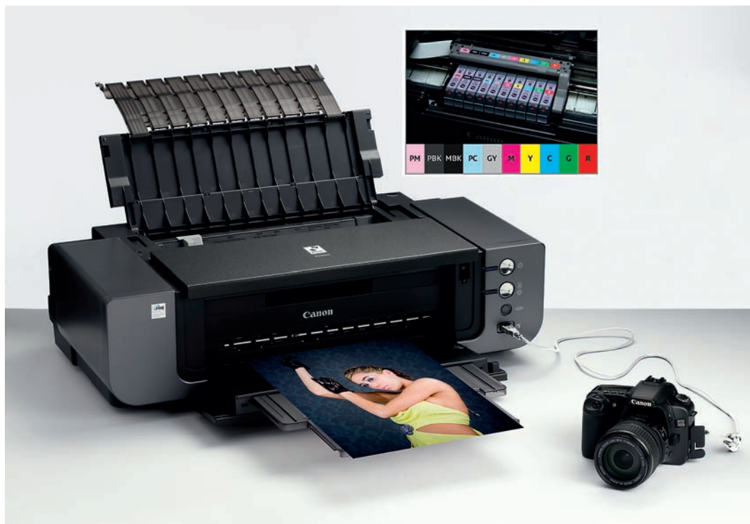
Slika 31. Fotokapljični tiskalnik za avtorsko ali studijsko uporabo ima v tiskovni glavi šest ločenih kartuž za tiskarska črnila C1 + C2 + M1 + M2 + Y + K. Nekateri imajo namesto dveh pisanih barv dve črni (sivi), da lepše natisnejo črno-bele slike, drugi tudi do deset kartuž s procesnimi barvami. Tiskovna glava upodablja sliko v obeh smereh ( bi-directional ), tiskovni material pa se giblje pod njo enosmerno. Tiskalniki te vrste uporabljajo tiskarska črnila na podlagi barvil ali pigmentov. Pigmentna so svetlobno bolj obstojna, barvila pa ponujajo več možnosti pri tiskanju različnih materialov (folije, tekstil, preslikači ipd.).
