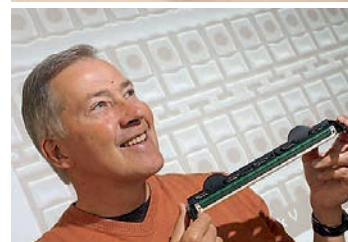
Slika 45. Stacionarna tiskovna letev s tiskovnimi glavami in kartušami MEMJET.
