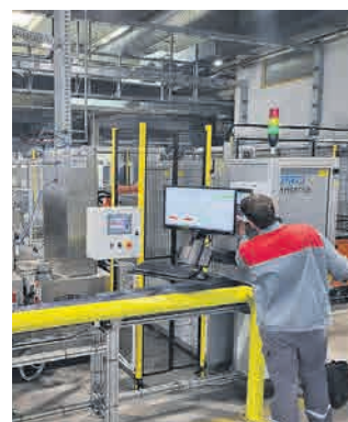
S strojnim vidom bodo v Talumu sledili strategiji proizvodnje ulitkov brez napak
