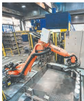
Z robotom za avtomatsko zlaganje rondel so v Talumu razbremenili sodelavce.
