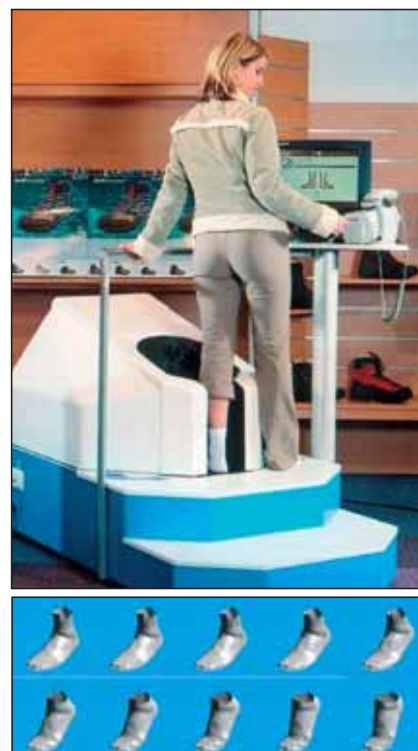
Slika 3. Zgoraj: Prva generacija laserskih merilnikov stopal, razvitih v KOLT-u. Spodaj: Primer meritve oblike stopala med sonožnim poskokom. Časovni interval med dvema zaporednima izmerkoma znaša 1/25 sekunde.
