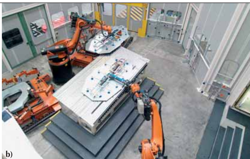
Slika 2. Ločevalnik in dodajalnik pločevine: a – tloris, b – fotografija
