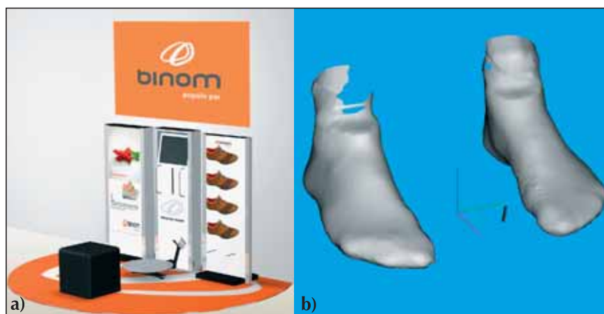
Slika 4. a) Druga generacija laserskih merilnikov stopal, razvitih v KOLT-u. b) Primer meritve oblike stopala. Sočasna meritev obeh stopal traja 10 sekund.
