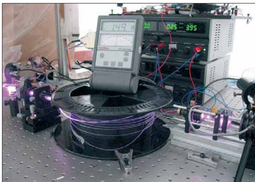
Slika 9. Laboratorijska izvedba kontinuirnega vlakenskega laserja med delovanjem
