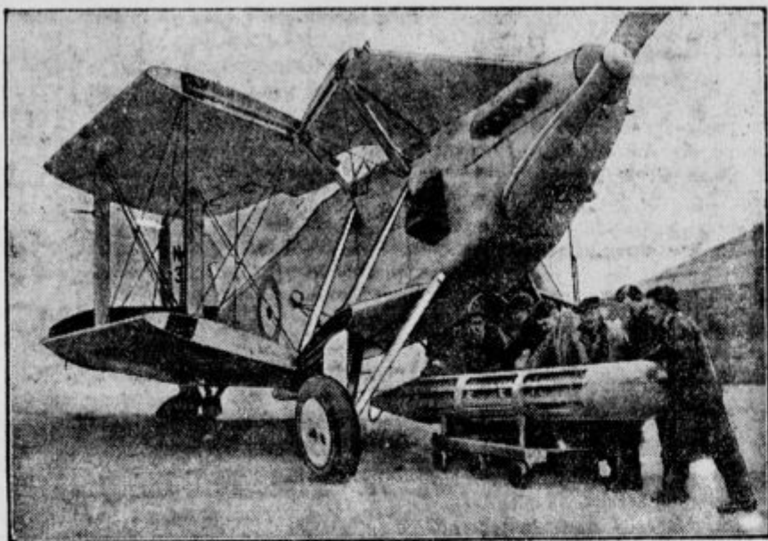
Najmodernejše angleško bojno letalo, ki je oboroženo s strojnimi puškami, majhnimi topovi, metalci min in celo s cevjo za lansiranje torpedov. Njegova hitrost znaša 210 km na uro.
