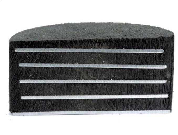
Slika 9 • Sestava potresnega izolatorja
