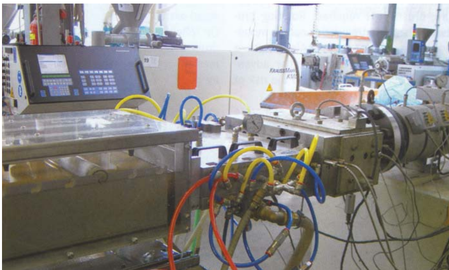
Slika 2: Orodje, kalibrirna enota in vakuumski hladilni rezervoar. Značilen sestav orodja GRUBER & CO za ekstrudiranje lesa: segreto orodje, s tekočino hlajene plošče orodja, suha kalibrirna enota, vakuumski hladilni rezervoar.
