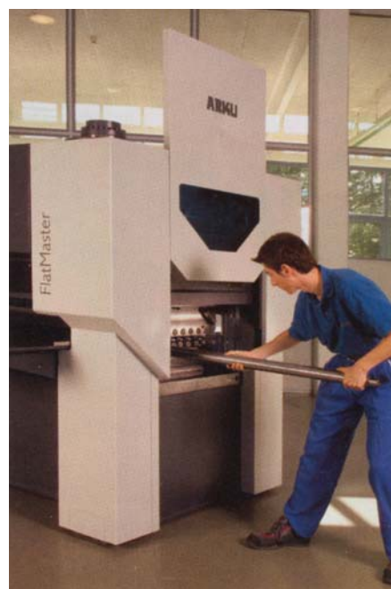
Preprosto in gospodarno: Sistem za hitro menjavo valja za ravnanje olajša redno čiščenje.
