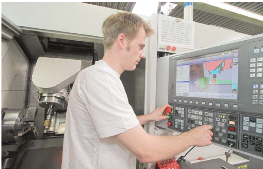
Novo krmilje PC-CNC OSP-P200 omogoča neomejeno uporabo programov v okolju Windows XP. 15-colski zaslon na dotik je namenjen udobnemu vnašanju in prikazovanju podatkov. Operater lahko uporablja tudi običajno USB-miško. Vnos dodatnih besedil za NC-programe omogoča alfanumerična tipkovnica.
