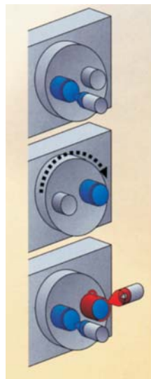
Slika 5: Princip delovanja vrtljive mize in primer uporabe
