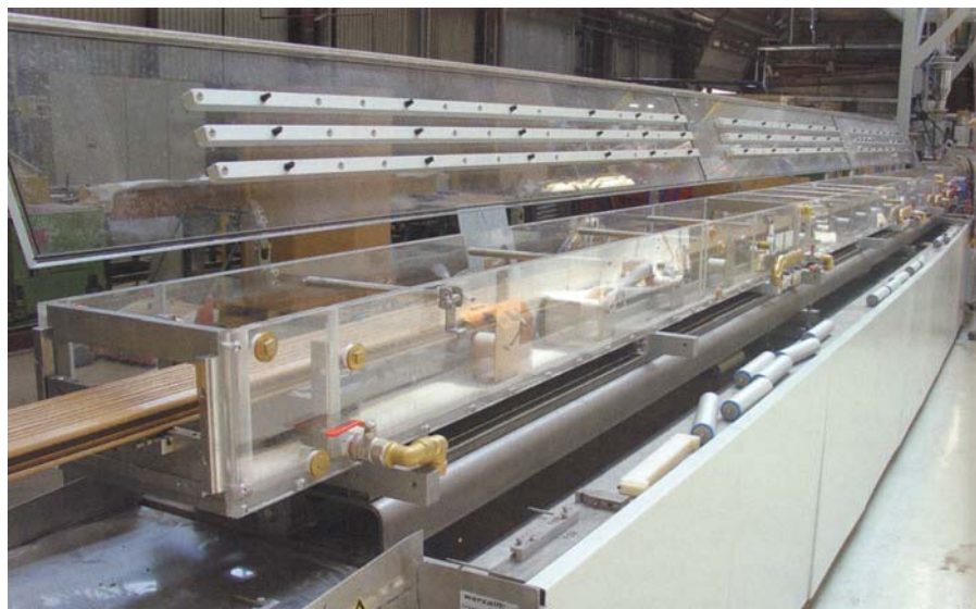
Slika 3: Vakuumski hladilni rezervoar in kalibracijska miza. Za hitrost ekstrudiranja 2 m/min. je potreben hladilni del, dolg 10 m. Na začetku so pokrovi še dvignjeni. Najprej se vstavijo vodilni valji in montirajo tesnilni pokrovi.
