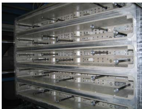
Slika 4: Zapiranje orodja, kjer so vidni izmetači
