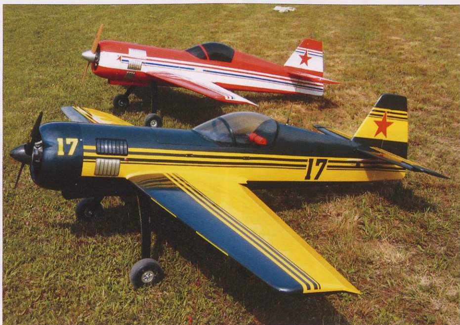
Marko Mencin je avtor samogradne, klasično zasnovane makete akrobatskega letala suhoj Su-26 z bencinskim motorjem MVVS 26 cm 3 .
