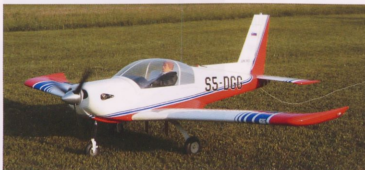
Maketa športnega letala zlin 242, namenjenega aerovleki, proizvajalca JR models, ki jo poganja bencinski bokerski motor ZDZ 80 cm 3 , je delo modelarja Bodgana Makuca.
