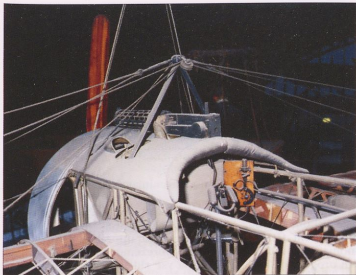
Fokker E.III, verjetno 210/16, je še vedno razstavljen v Narodnem muzeju znanosti in industrije v Londonu. Letalo je razstavljeno brez platnene prevleke. Na sliki je dobro vidna pilotska kabina.
