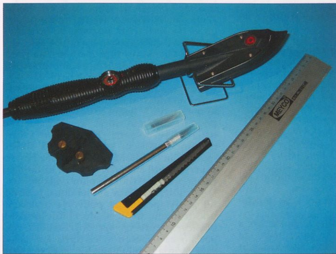
Osnovno orodje, ki ga potrebujemo za prekrivanje: modelarski likalnik z možnostjo nastavljanja temperature, pripomoček za rezanje folije, skalpel z rezervnimi rezili, modelarski nož in kovinsko ravnilo.
