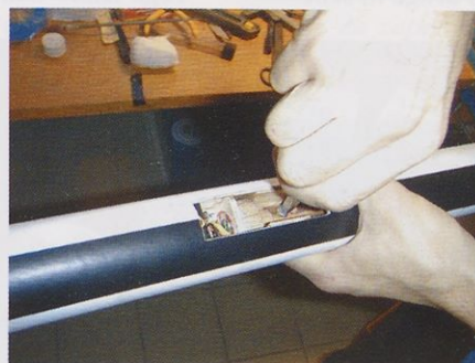
Na modelu so zaradi lažjega dostopa do elektronike, ko je ta že v raketi, narejena vrata.
