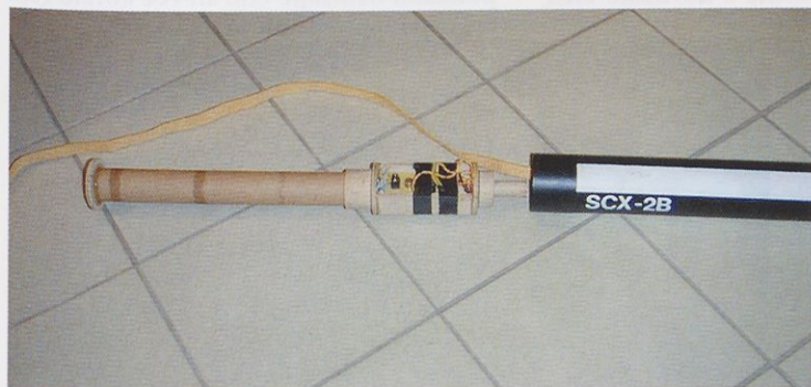
Časovnik pred vgraditvijo v model. Na levi je cev, v kateri je spravljen padalo z vžigalnikom in odbojnim polnjenjem.
