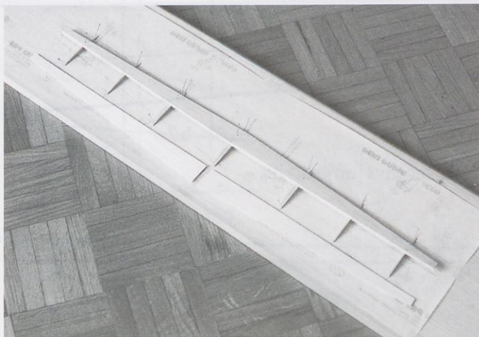
Slika 4. Na rebra najprej prilepimo oba sprednja dela krila ...
