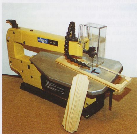
Slika 14. Pri izdelavi podstavka za maketo kliperja lahko izkoristite prednosti, ki jih ponuja električna reziljača. To so: možnost žaganja masivnega lesa večje debeline, izžaganje poljubnih oblik in žaganje pod želenim kotom (v tem primeru 15°).
