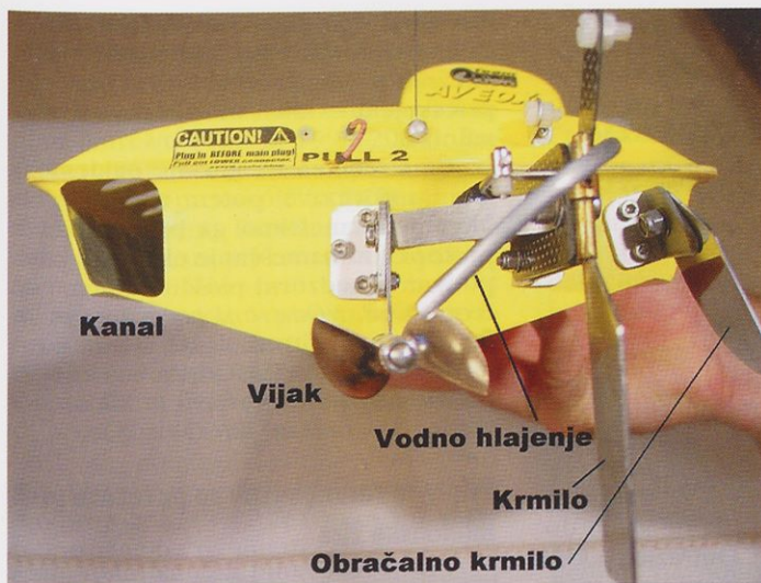
Težišče je pri modelih mono 1 in 2 za stopnico (slika zgoraj).
