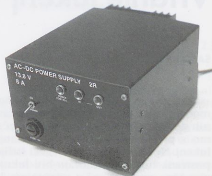
Na prednjo stran ohišja montiramo stikalo, varovalko, izhodne puše in kontrolne LED-diode.
