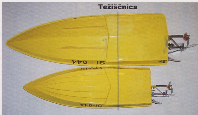
Težišče je pri modelih mono 1 in 2 za stopnico (slika zgoraj).
