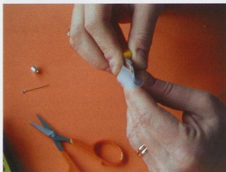
Slika 3. Lepilni trak s škarjami ali modelarskim nožem obrežite ob robu cevke.
