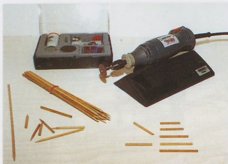
Slika 5. V Minicraftovem kompletu MX 2 so tudi rezalne ploščice, s katerimi je mogoče brez težav in zelo natančno rezati lesene paličice.
