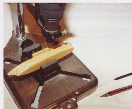
Slika 4. V ograjo krova dokončno obdelanega trupa je treba z 1-milimetrskim svedrom izvrćtati luknjice za pritrditev jambornih vrvi.
