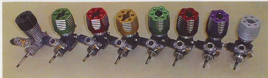
Slika 1. Različni 3,5-kubični motorji za avtomobilske modele v merilu 1 : 8
