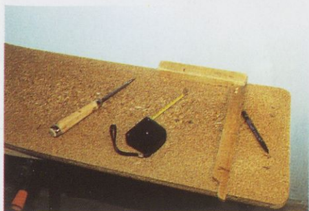
Slika 4. Zarisovanje položaja izvrtin za vijake na nasprotni strani likalne površine
