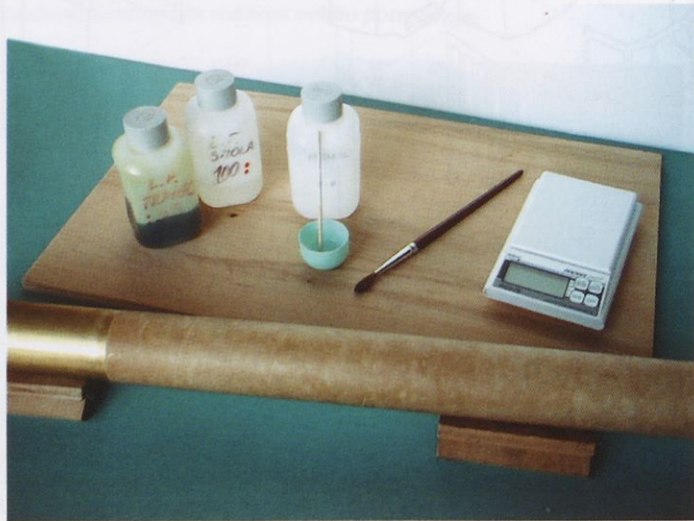
Slika 5. Površino trupa premažemo z epoksidno smolo, razredčeno z nekaj kapljicami metanola. Sestavine je treba natančno odtehtati.
