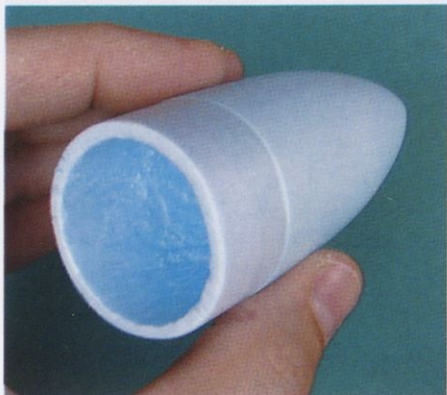
Slika 10. Glavo izvotlimo z modelarskim nožem ali skalpelom, da je čim lažja. Glava na sliki tehta 1,8 g.
