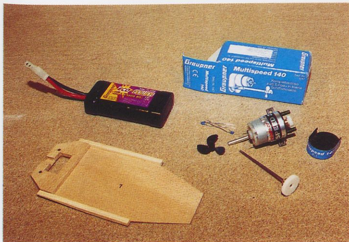
Slika 9. Nosilec je prilagojen motorju iz Graupnerjevega pogonskega kompleta Multispeed 140 (kat. št. 1147).
