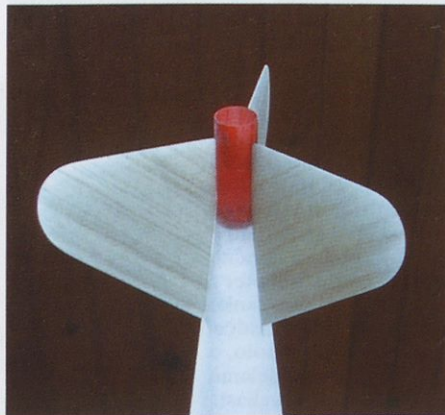
Slika 11. Pri izrezovanju stabilizatorjev skrbno pazimo na smer letnic v balzi.
