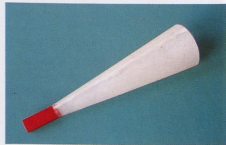
Slika 4. Adapter je prilepljen neposredno na cev nosilca motorja.
