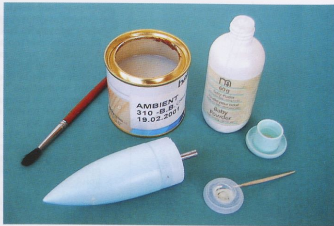
Slika 9. Modelarski kit za stirodurno glavo mora biti na vodni osnovi. Pripravimo ga lahko z brezbarvnim Belinkinim akrilnim lakom Ambient, ki mu dodamo ustrezno količino smukca ali otroškega pudra.
