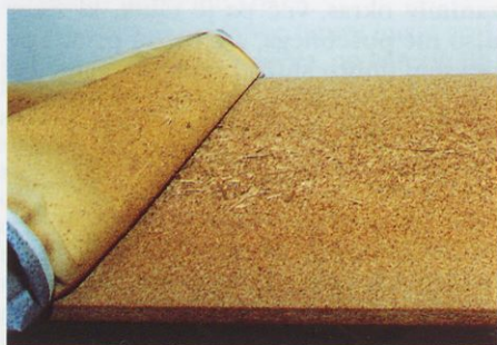
Slika 1. Vлага, ki med likanjem prodira skozi prevleko v likalno površino, povzroči razpadanje iverne plošče.
