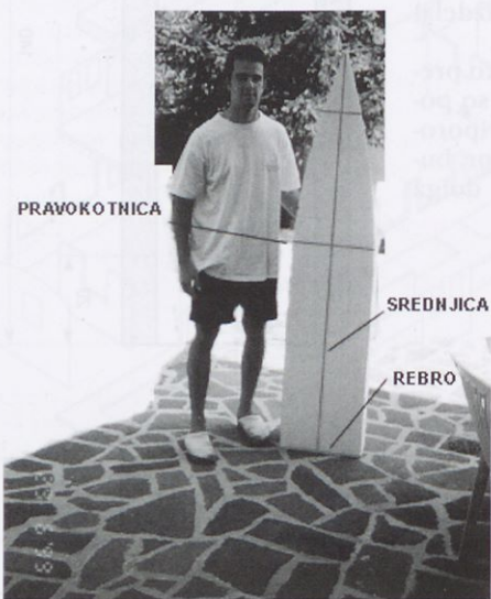
Oznake na bloku stiropora so v pomoč pri rezanju.
