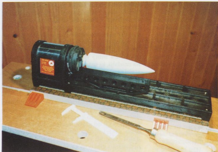
Slika 8. Na Mantuini modelarski stružnici lahko izdelamo tudi nekoliko večje glave iz stirodura.
