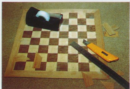
Slika 10. Trakove furnirja, iz katerih je narejena obroba šahovnice, na vogalih zarežite pod kotom 45°.
