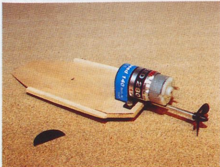
Slika 11. Zaščitnemu plastičnemu pokrovčku zobniškega prenosa je treba zaradi kasnejše možnosti snemanja odžagati spodnji, polkrožno oblikovani del.
