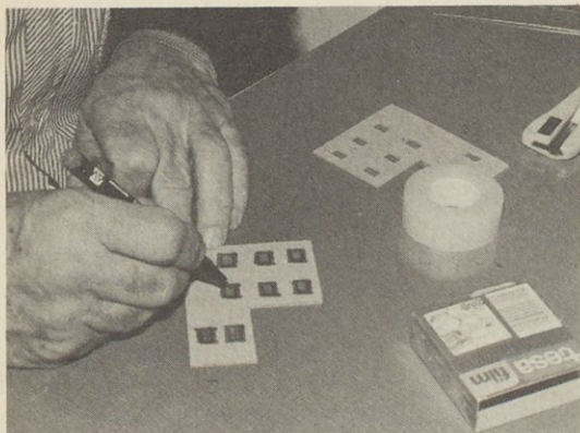
Slika 8. Nato s tanjšim vodoodpornim flomastrom narišemo še okenske križe. Navaden flomaster na plastični trak ne bo prijel.
