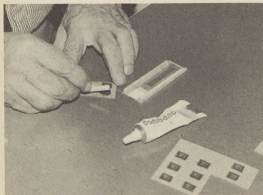
Slika 10. Na ožje stene ob robove nalepimo 4 \times 4 mm debelo letvico. Lepilo DONIBOND namažemo na steno in letvico ter po nekaj minutah združimo.
