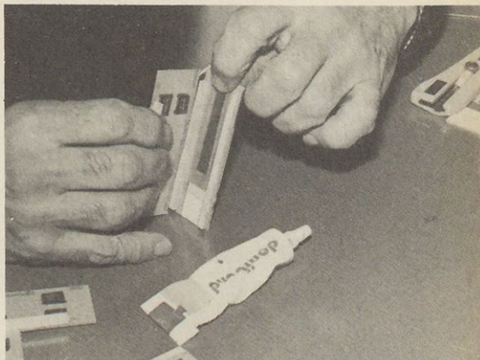
Slika 11. Lepilo namažemo na rob širše stene in na prilepljene letvice. Čez pet minut obe steni zlepimo skupaj. Letvice v robovih povečajo lepilno površino in dajo hišici večja stabilnost.
