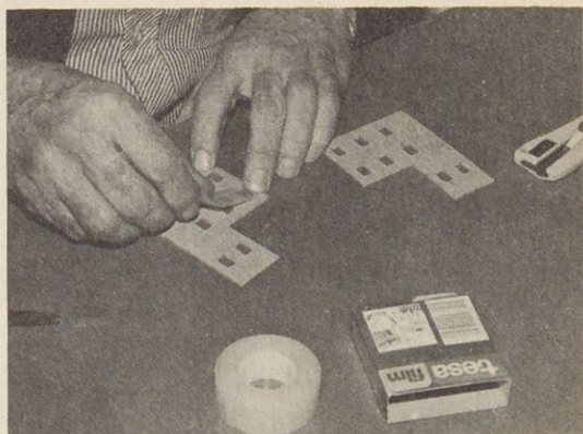
Slika 6. Raje pa bomo na enostaven način tudi okna naredili sami. Na notranjo stran sten nalepimo preko okenskih odprtin prosojni samolepilni trak.
