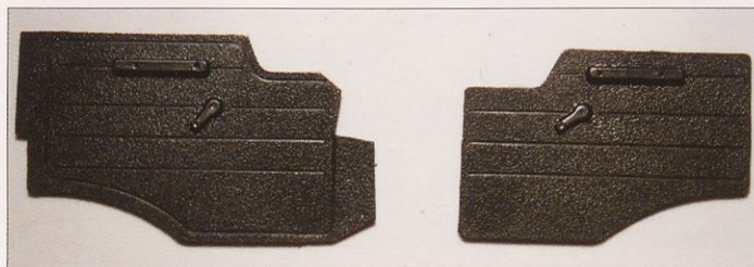
Slika 1. Na levi strani je neobrezana notranja obloga vrat, ki prekrije celotno notranjo stran kabine in ni bila pravilne oblike. Na levi strani je pravilno obrezana obloga.
