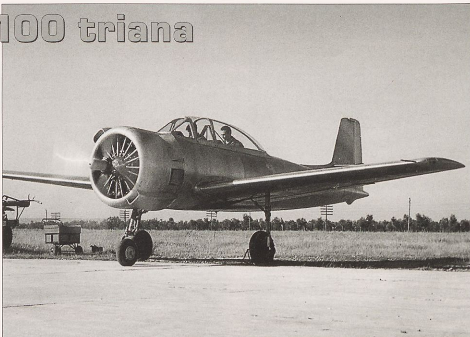
HA-100 je bilo na pogled zelo elegantno letalo kljub precej velikemu nosu, v katerem pa je bil v aerodinamično dognanem ohišju nameščen zvezdast motor.
