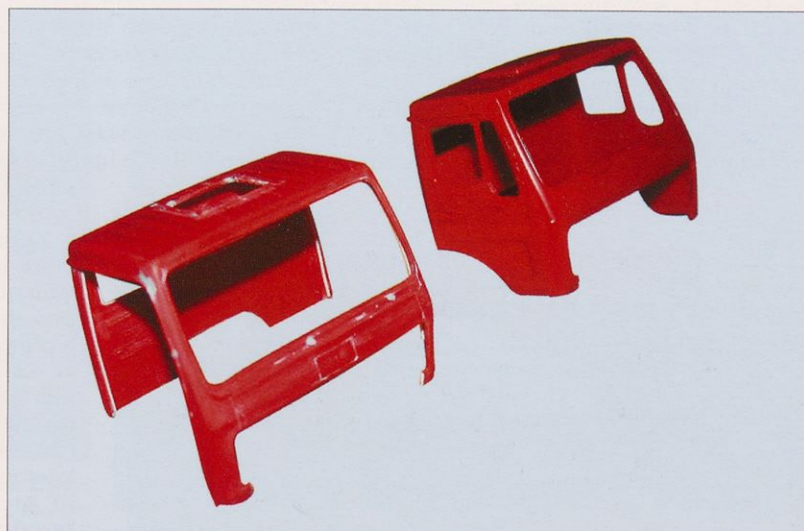
Slika 4. Na levi strani je popolnoma predelana kabina, na desni pa še nedotaknjena kabina iz škatle.
