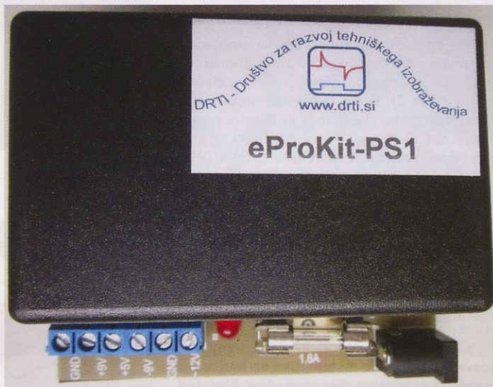
Slika 7. Napajalnik, ki omogoča naslednje napajalne napetosti vezij (+5 V, +9 V, -9 V in izmenično napetost 12 V).
