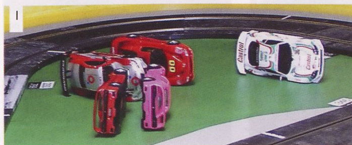
1. Čakajoči modeli so zaradi občutljivih drsnikov (pletence) položeni na bok 2. Elektronski števec krogov
