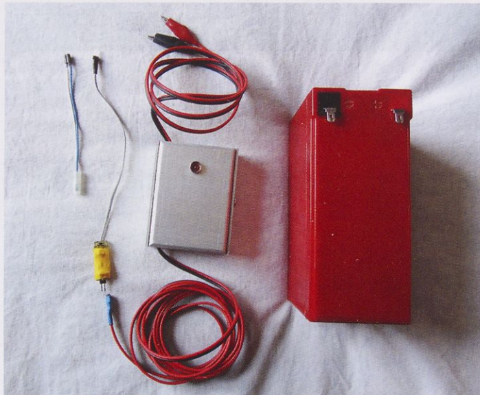
Napajalnik časovnika TEV. Elektroniko zapremo v primerno ohišje. Oba kabelska priključka morata biti dovolj varna pred izvlečenjem.
