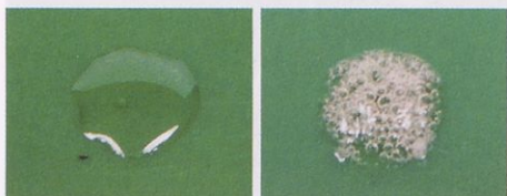
Če nanos lepila popršimo z vodo, se speni, volumen pa se zelo poveča.
