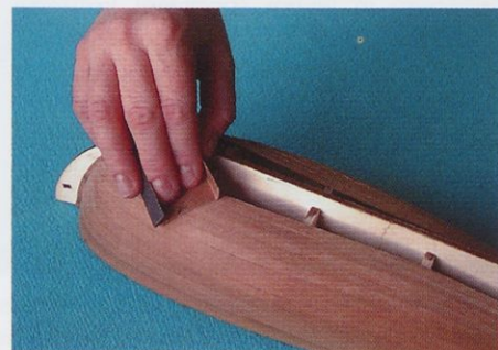
Slika 4. Površino dokončno zgladimo s finim vodnobrašilnim papirjem.
