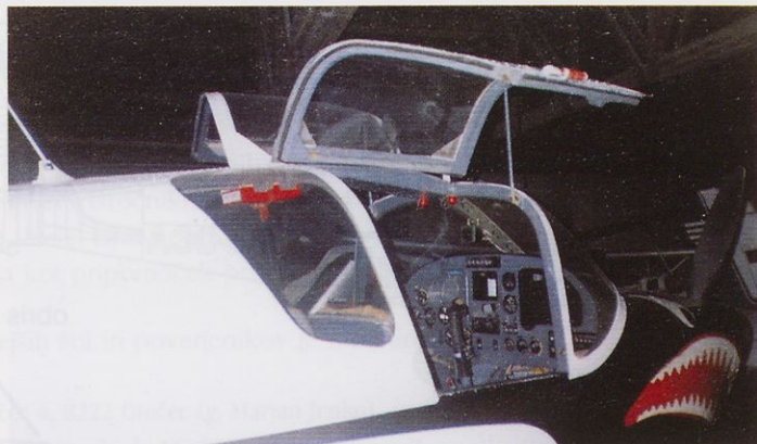
Pogled skozi odprt pokrov kabine utve-75. Instrumentna plošča in notranji okvirji kabine so srednje sivi (razen srednjega okvirja pod vetrobranom, ki je rablo zelenkaste barve), instrumenti črni, palici sivi s črnima držaloma, tla so iz temnejše sivega tapisona, stranski steni pa sta obledele rdečerjave barve. Bodite pozorni na rdeče ročice za odpiranje kabine in prav tako rdečo škatlo prve pomoči, vidno pod okvirjem zadnjega dela kabine.
