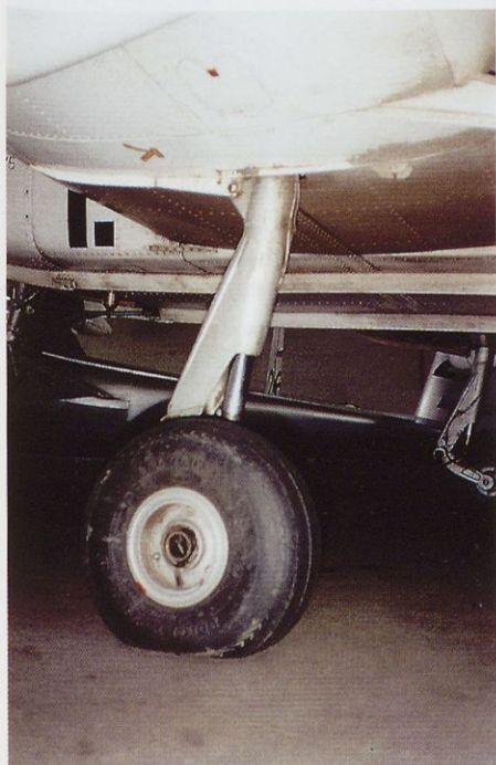
Glavno podvozje celjske utve. Da letalo že dolgo kraljuje v bangarju, je vidno tudi po napol praznih pnevmatikah.
