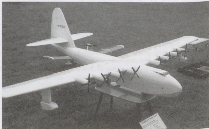
Pri večmotornih in vodnih letalib je električni pogon absolutni zmagovalec. Maketo letala hughes H4 "spruce goose" z razpetino krila 244 cm in maso 6,14 kg poganja 8 motorjev speed 400, ki se napajajo iz 28 celic kapacitete 1700 mAh.
