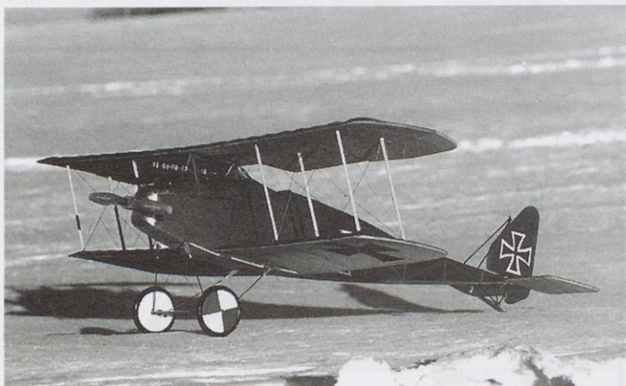
V zimskem vremenu nam elektromotorji, v primerjavi z motorji z notranjim zgorevanjem, ne povzročajo nobenih težav. Maketo letala halberstadt D II z razpetino krila 91 cm in maso 609 g poganja motor speed 400, ki se napaja iz 8 celic kapacitete 600 mAh.
