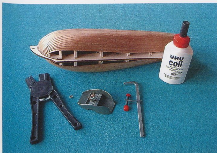
Slika 5. Oblepljanje z letvicami je zamudno in natančno opravilo, pri katerem si pomagamo z različnimi svorami, ščipalkami, elastikami itd. Sprva brava in precej neugledno površino korita (leva slika) popolnoma zgladimo z uporabo finih pil in brusilnega papirja različnih zrnatosti (slika desno).
