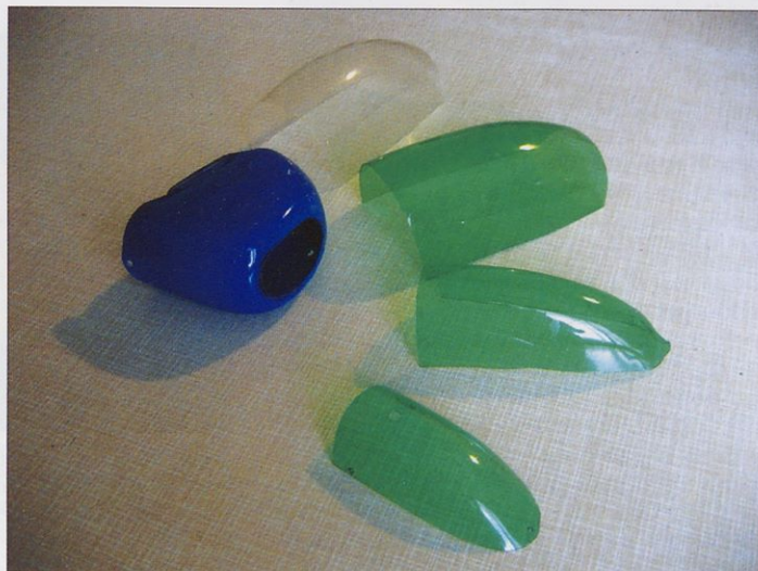
S kuhanjem izdelani pokrovi kabin in nos za letalski model.
