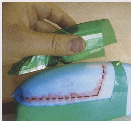
Plastiko ločimo od kalupa. Odrezali smo malce večji kos, ki ga bomo natanko na mero obrezali pri montaži na model.
