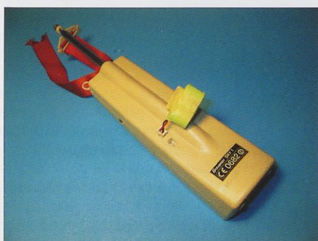
Pogonski akumulator malega plesalca napolnimo kar na oddajniku – akumulatorji so polni po dveh minutah, ko se začnejo rahlo greti.
