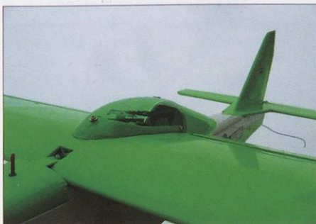
Doma narejeni pokrov kabine za motorni model
