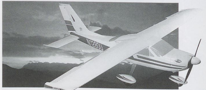
Polmaketa ameriškega letala cessna 177 cardinal (Teltech) z razpetino 2800 mm, dolžino 1980 mm, maso od 12-15 kg in obtežbo kril 127 g/dm 2 je prirejena za pogon z eksplozijskimi motorji od 45 cm 3 naprej.
