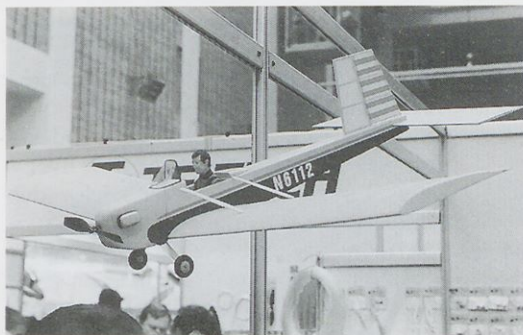
Teltechov model letala volksplane na električni pogon je tako kot vsi njegovi modeli prekrit s folijo Oracover.
