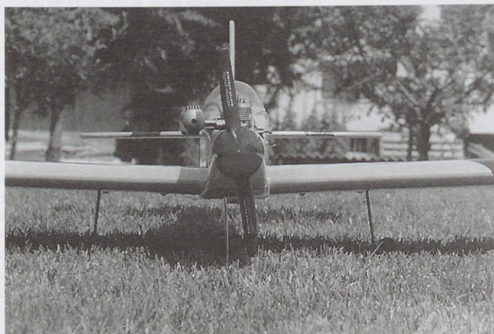
Slika 9. Model leti dokaj hitro, saj mu to omogočajo skladne aerodinamične linije. Na sliki je viden tudi enakomeren prehod krila v trup.
