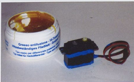
Zgornji del servomehanizma ob pogonski osi zatesnimo z mastjo.
