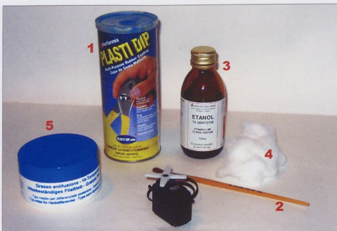
Material, ki ga potrebujemo za tesnjenje servomehanizma: 1 - tekoča guma, 2 - čopič za nanašanje gume, 3 - alkohol, 4 - vata za čiščenje, 5 - mast za plastične dele
