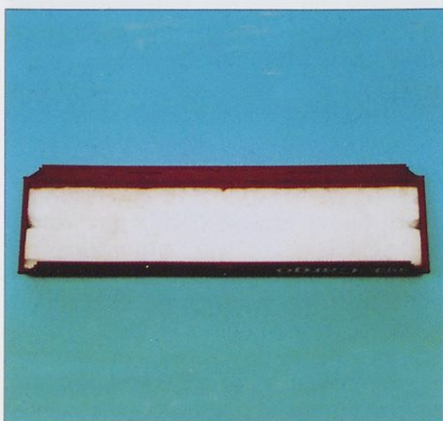
Stiroporni vložek z lepilom za stiropor s spodnje strani prilepimo v zgornji del (levo).
