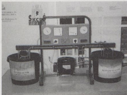
Toplotna črpalka, ki so jo izdelali dijaki Srednje kovinarske in cestnoprometne šole iz Škofje Loke
