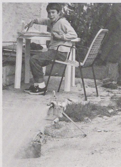
Naprava za merjenje sile motorjev »tip 2« ima dva kroglična ležaja, ki omogočata pritisk motorja na bat z zelo malo trenja. Kot merilna utež služi z betonom napolnjena pločevinka znane mase
