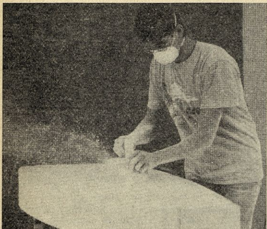
Slika 13. Brušenje: Z obličem zravnamo spodnjo in zgornjo površino in se tako bližamo končni obliki.
